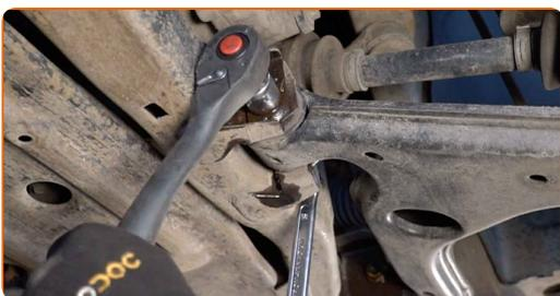
**11** Χαλαρώστε το οπίσθιο στοιχείο στερέωσης του βραχίονα ελέγχου. Χρησιμοποιήστε ένα καρυδάκι #18. Χρησιμοποιήστε ένα γερμανοπολύγωνο #18. Χρησιμοποιήστε μια καστάνια.
