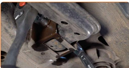
**12** Ανοίξτε το στοιχείο στερέωσης που συνδέει το μπαλάκι του βραχίονα ελέγχου με το μπουαγιέ. Χρησιμοποιήστε ένα ίσιο σκαρπέλο μετάλλου. Χρησιμοποιήστε ένα σφυρί.
