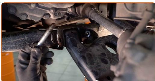
**15** Αφαιρέστε το ψαλίδι. Χρησιμοποιήστε ένα λοστό.
