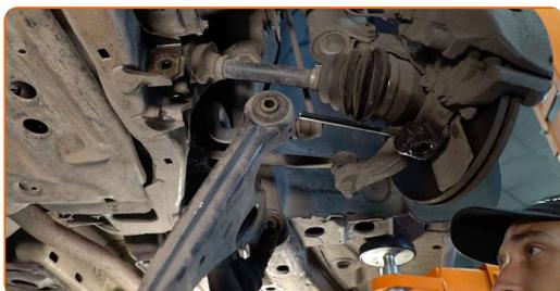
**16** Καθαρίστε τις βάσεις τοποθέτησης και το σπείρωμα του ψαλιδιού της ανάρτησης. Χρησιμοποιήστε μια συρματόβουρτσα. Χρησιμοποιήστε σπρέι WD-40.
