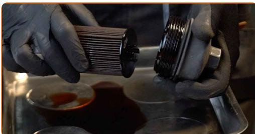
**15** Αφαιρέστε το ο-ρινγκ του καπακιού του φίλτρου. Χρησιμοποιήστε ένα ίσιο κατσαβίδι.
