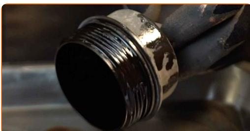
**16** Καθαρίστε το καπάκι του περιβλήματος του φίλτρου λαδιού. Χρησιμοποιήστε ένα σπρέι καθαρισμού γενικής χρήσης.
