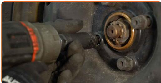
**19** Χαμηλώστε το αυτοκίνητο και χρησιμοποιήστε σταυρό, προκειμένου να σφίξετε τα μπουλόνια των τροχών. Χρησιμοποιήστε ένα δυναμόκλειδο. Σφίξτε τη με ροπή 110 Nm.
