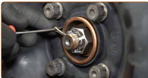
3 Χαλαρώστε τα στοιχεία στερέωσης του ημιαξονίου. Χρησιμοποιήστε ένα καρυδάκι #30. Χρησιμοποιήστε μια μανέλα κολαούζου.
