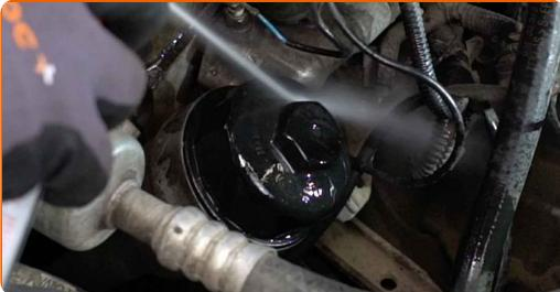
6 Ξεβιδώστε το καπάκι του καλύμματος του φίλτρου μαζί με το παλιό στοιχείο φιλτραρίσματος. Χρησιμοποιήστε ένα καρυδάκι #32. Χρησιμοποιήστε μια καστάνια.
