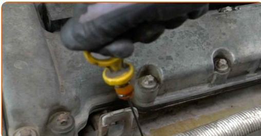
5 Καθαρίστε το καπάκι του περιβλήματος του φίλτρου λαδιού. Χρησιμοποιήστε ένα σπρέι καθαρισμού γενικής χρήσης.
