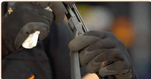
**Αντικατάσταση: μάκτρο καθαριστήρα - OPEL Corsa A Van (S83).**
