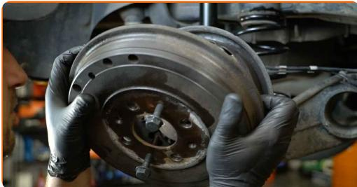
**Αντικατάσταση: ρουλεμάν τροχού - OPEL Corsa C Hatchback (X01).**
