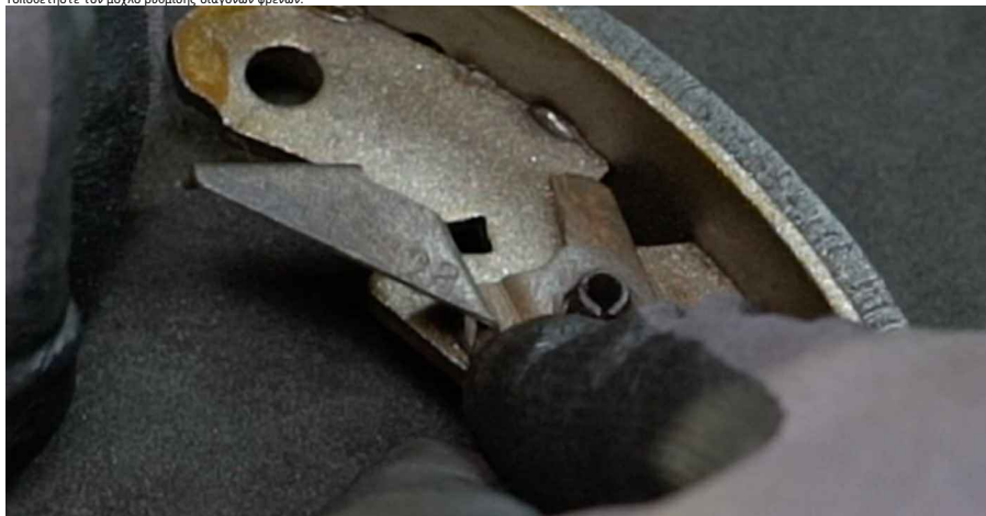
34 Τοποθετήστε τον δακτύλιο ασφαλείας.
