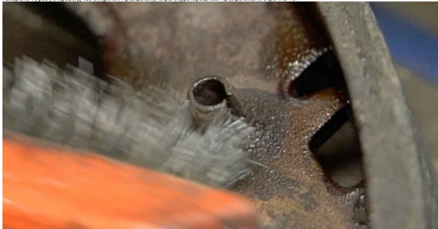
30 Βγάλτε το ανεμπλόκ. Χρησιμοποιήστε μια γκαζοτανάλια.
