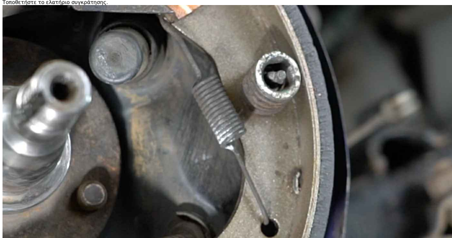
40 Τοποθετήστε το άνω ελατήριο επαναφοράς. Χρησιμοποιήστε μυτοτσιμίδα μακριάς λαβής.
