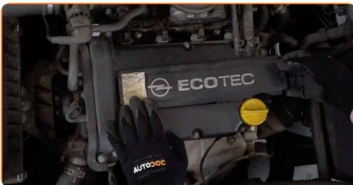
**3** Ξεκουμπώστε τη φίσα από τον πολλαπλασιαστή. Χρησιμοποιήστε ένα ίσιο κατασβίδι.
