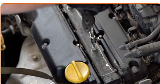
**5** Σηκώστε τον πολλαπλασιαστή. Χρησιμοποιήστε ένα λοστό.
