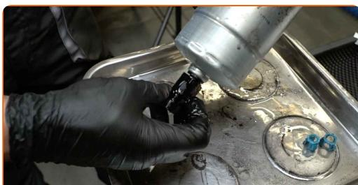
**Αντικατάσταση: φιλτρο καυσιμου - OPEL Corsa E Hatchback (X15).
