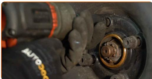
**23** Χαμηλώστε το αυτοκίνητο και χρησιμοποιήστε σταυρό, προκειμένου να σφίξετε τα μπουλόνια των τροχών. Χρησιμοποιήστε ένα δυναμόκλειδο. Σφίξτε τη με ροπή 110 Nm.
