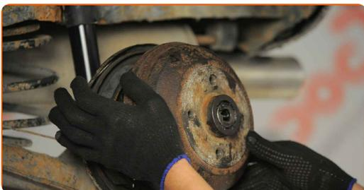
**23** Βιδώστε το στοιχείο στερέωσης του μουαγιέ τροχού. Χρησιμοποιήστε ένα γερμανοπολύγωνο #24. Χρησιμοποιήστε μια καστάνια.
