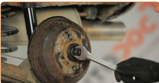
**24** Τοποθετήστε την κοπίλια του παξιμαδιού στερέωσης του ρουλεμάν της πλήμνης. Χρησιμοποιήστε ένα μυτοτσιμπίδο.
