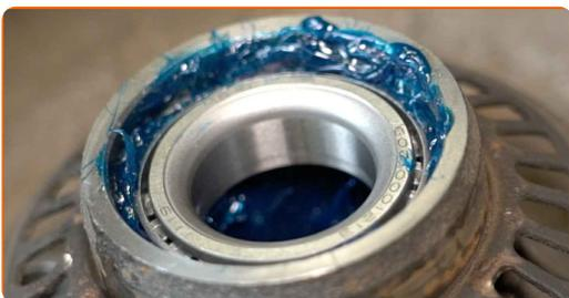
**22** Τοποθετήστε τη τσιμούχα λαδιού του ρουλεμάν τροχών.
