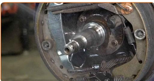
**24** Τοποθετήστε το ταμπόρο φρένων που έχει συναρμολογηθεί με το ροτλεμάν μουαγιέ τροχού.
