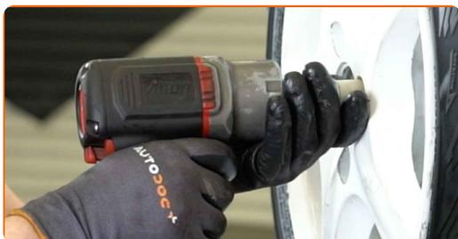
38 Χαμηλώστε το αυτοκίνητο και χρησιμοποιήστε σταυρό, προκειμένου να σφίξετε τα μπουλόνια των τροχών. Χρησιμοποιήστε κρουστικό καρυδάκι για μπουλονόκλειδο Νο #17. Χρησιμοποιήστε ένα δυναμόκλειδο. Σφίξτε τη με ροπή 110 Nm.
