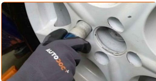
**26** Χαμηλώστε το αυτοκίνητο και χρησιμοποιήστε σταυρό, προκειμένου να σφίξετε τα μπουλόνια των τροχών. Χρησιμοποιήστε κρουστικό καρυδάκι για μπουλονόκλειδο Νο #17. Χρησιμοποιήστε ένα δυναμόκλειδο. Σφίξτε τη με ροπή 110 Nm.
