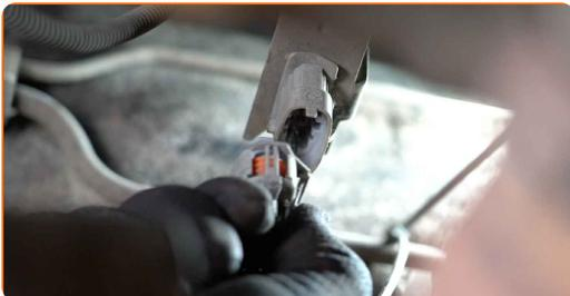
**5** Καθαρίστε το στοιχείο στερέωσης του αισθητήρα οξυγόνου. Χρησιμοποιήστε μια συρματόβουρτσα. Χρησιμοποιήστε σπρέι WD-40.
