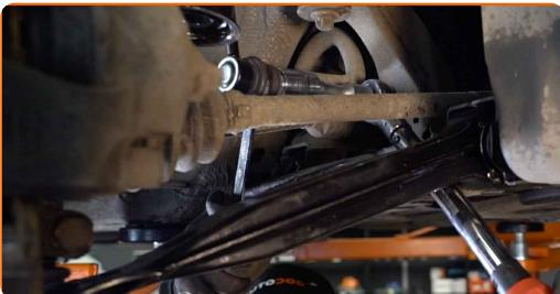
**11.2** Χρησιμοποιήστε ένα γερμανοπολύγωνο #19. Χρησιμοποιήστε ένα καρυδάκι #18. Χρησιμοποιήστε ένα δυναμόκλειδο. Σφίξτε τη με ροπή 65 Nm.
