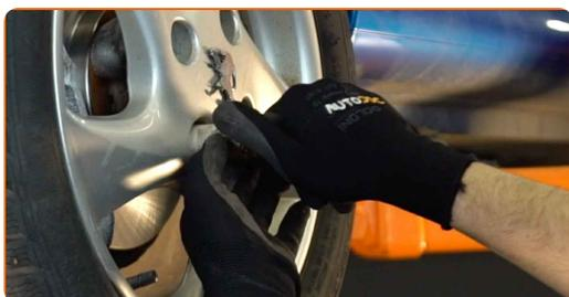
**21** Χαμηλώστε το αυτοκίνητο και χρησιμοποιήστε σταυρό, προκειμένου να σφίξετε τα μπουλόνια των τροχών. Χρησιμοποιήστε ένα δυναμόκλειδο. Σφίξτε τη με ροπή 100 Nm.
