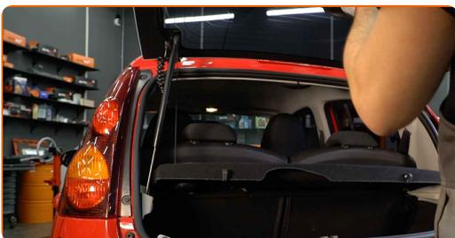
2 Στηρίξτε το καπό του πορτμπαγκάζ. Χρησιμοποιήστε ένα υδραυλικό γρύλο σασμάν.
