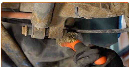
**7** Ξεβιδώστε το επάνω παξιμάδι του αμορτισέρ. Χρησιμοποιήστε ένα γερμανοπολύγωνο #19. Χρησιμοποιήστε ένα καρυδάκι #19. Χρησιμοποιήστε μια καστάνια.
