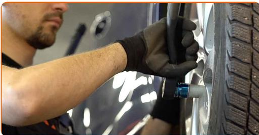
**34** Χαμηλώστε το αυτοκίνητο και χρησιμοποιήστε σταυρό, προκειμένου να σφίξετε τα μπουλόνια των τροχών. Χρησιμοποιήστε ένα δυναμόκλειδο. Σφίξτε τη με ροπή 100 Nm.
