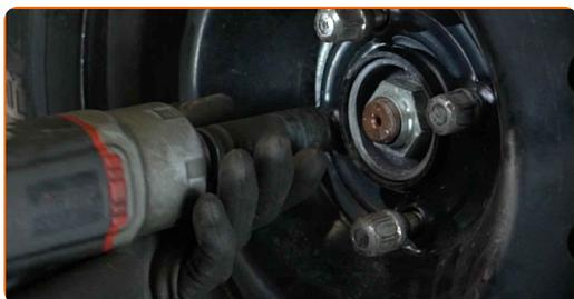
**21** Χαμηλώστε το αυτοκίνητο και χρησιμοποιήστε σταυρό, προκειμένου να σφίξετε τα μπουλόνια των τροχών. Χρησιμοποιήστε κρουστικό καρυδάκι για μπουλονόκλειδο No #19. Χρησιμοποιήστε ένα δυναμόκλειδο. Σφίξτε τη με ροπή 90 Nm.
