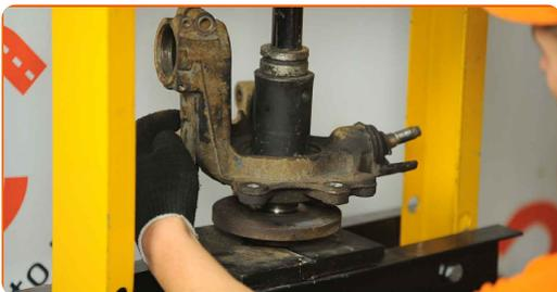
**47** Επεξεργαστείτε τη βάση του γόνατου του αμορτισέρ, επάνω στο μουαγιέ. Χρησιμοποιήστε μια συρματόβουρτσα. Χρησιμοποιήστε σπρέι WD-40.
