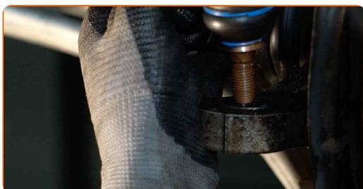
**63** Σφίξτε το παξιμάδι στερέωσης που συνδέει το μπαλάκι του ακρόμπαρου με το μουαγιέ. Χρησιμοποιήστε ένα καρυδάκι #17. Χρησιμοποιήστε ένα δυναμόκλειδο. Σφίξτε τη με ροπή 35 Nm.
