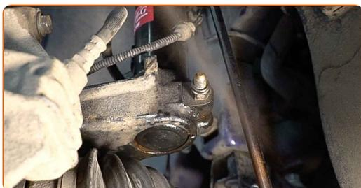
**78** Επεξεργαστείτε την επιφάνεια που ακουμπά ο δίσκος του φρένου στη ζάντα του τροχού. Χρησιμοποιήστε κεραμικό γράσο υψηλής θερμοκρασίας.
