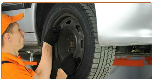
**7** Καθαρίστε τα στοιχεία στερέωσης της βάσης της δαγκάνας των φρένων. Χρησιμοποιήστε μια συρματόβουρτσα. Χρησιμοποιήστε σπρέι WD-40.
