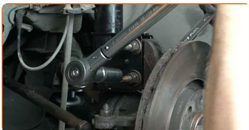
**36** Σφίξτε το παξιμάδι του άξονα κίνησης. Χρησιμοποιήστε ένα καρυδάκι #36. Χρησιμοποιήστε ένα δυναμόκλειδο. Σφίξτε τη με ροπή 280 Nm.
