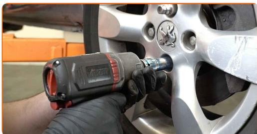
**46** Χαμηλώστε το αυτοκίνητο και χρησιμοποιήστε σταυρό, προκειμένου να σφίξετε τα μπουλόνια των τροχών. Χρησιμοποιήστε κρουστικό καρυδάκι για μπουλονόκλειδο Νο #17. Χρησιμοποιήστε ένα δυναμόκλειδο. Σφίξτε τη με ροπή 100 Nm.
