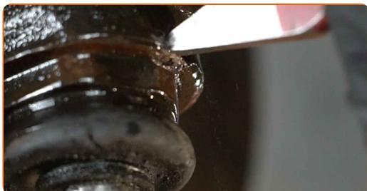
**19** Ξεβιδώστε τη βίδα του μπαλακιού που βρίσκεται στο μουαγιέ. Χρησιμοποιήστε ένα καρυδάκι #41. Χρησιμοποιήστε μια κασάνια.
