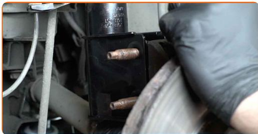
**34** Βιδώστε το στοιχείο στερέωσης που συνδέει το δίχαλο του αμορτισέρ με το μουαγιέ. Χρησιμοποιήστε ένα γερμανοπολύγωνο #18. Χρησιμοποιήστε ένα καρυδάκι #18. Χρησιμοποιήστε μια καστάνια.
