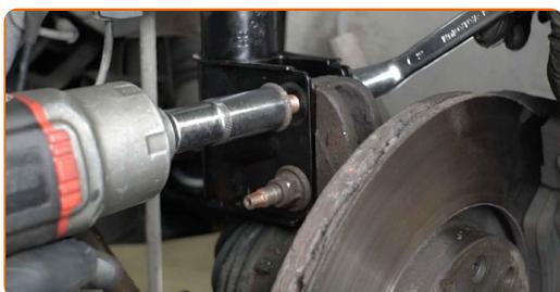
**35** Σφίξτε τα κάτω στοιχεία στερέωσης που συνδέουν το γόνατο του αμορτισέρ με το μουαγιέ του τροχού. Χρησιμοποιήστε ένα γερμανοπολύγωνο #18. Χρησιμοποιήστε ένα καρυδάκι #18. Χρησιμοποιήστε ένα δυναμόκλειδο. Σφίξτε τη με ροπή 90 Nm.
