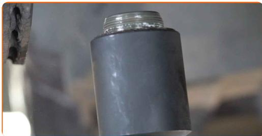
**21** Καθαρίστε το σημείο τοποθέτησης του μπαλακιού του ακρόμπαρου. Χρησιμοποιήστε μια συρματόβουρτσα. Χρησιμοποιήστε σπρέι WD-40.
