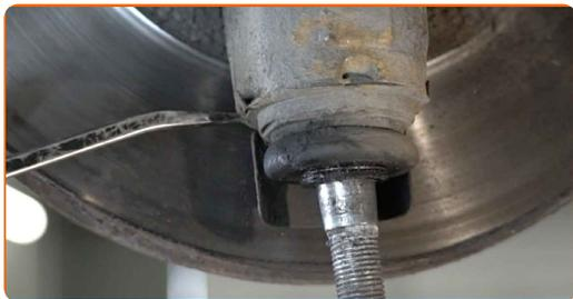
**17** Καθαρίστε το στοιχείο στερέωσης που συνδέει το μπαλάκι του ακρόμπαρου με το μουαγιέ. Χρησιμοποιήστε μια συρματόβουρτσα. Χρησιμοποιήστε σπρέι WD-40.
