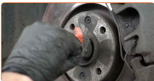
**7** Αφαιρέστε την κοπίλια του παξιμαδιού του άξονα μετάδοσης κίνησης. Χρησιμοποιήστε ένα ζουμπά.
