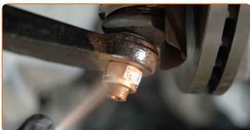
**41** Καθαρίστε το σημείο τοποθέτησης της ζάντας του τροχού. Χρησιμοποιήστε μια συρματοβούρτσα.
