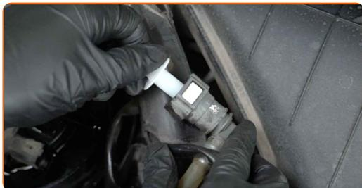
**8** Ξεβιδώστε τα στοιχεία στερέωσης του καλύμματος του περιβλήματος του φίλτρου αέρα. Χρησιμοποιήστε ένα καρυδάκι #27. Χρησιμοποιήστε μια καστίνα.
