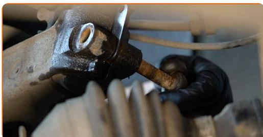
**27** Απελευθερώστε το κάτω στοιχείο στερέωσης που συνδέει το γόνατο του αμορτισέρ με το μουαγιέ. Χρησιμοποιήστε ένα ειδικό καρυδάκι για να βγάλετε το αμορτισέρ. Χρησιμοποιήστε μια κασάνια.
