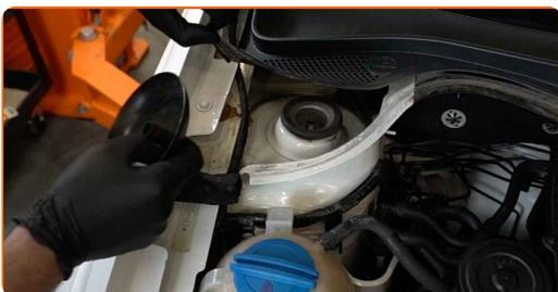
**6** Καθαρίστε τα στοιχεία στερέωσης της επάνω βάση του γόνατου του αμορτισέρ. Χρησιμοποιήστε μια συρματόβουρτσα. Χρησιμοποιήστε σπρέι WD-40.
