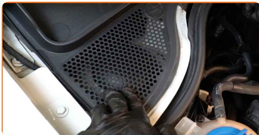
**74** Τοποθετήστε την τσιμούχα του τροπέτου των υαλοκαθαριστήρων.
