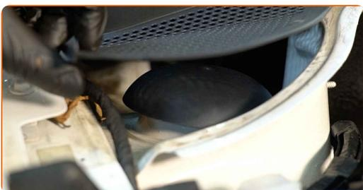
**73** Τοποθετήστε και ασφαλίστε του τροπέτο των υαλοκαθαριστήρων.
