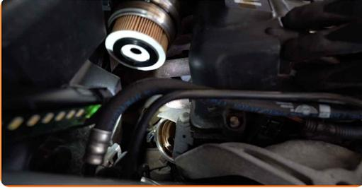
22 Βιδώστε το καπάκι. Χρησιμοποιήστε ένα καρυδάκι 76-14F. Χρησιμοποιήστε ένα δυναμόκλειδο. Σφίξτε τη με ροπή 25 Nm.
