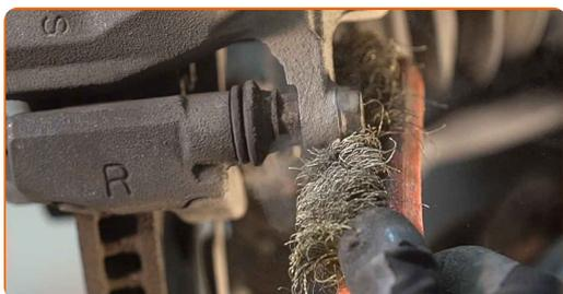
**9** Ξεβιδώστε τον σφιγκτήρα της δαγκάνας των φρένων. Χρησιμοποιήστε ένα καρυδάκι #14. Χρησιμοποιήστε μια καστίνα.
