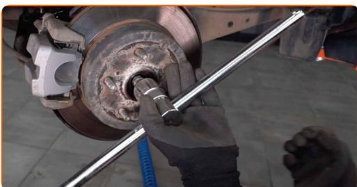
**10** Περάστε από επεξεργασία τις σφήνες του μπιλιοφόρου του ημιαξονίου. Χρησιμοποιήστε σπρέι WD-40.
