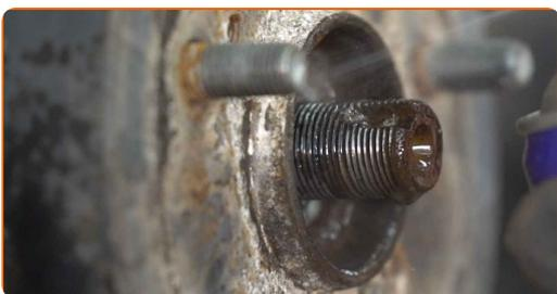
**11** Αφαιρέστε τον άξονα κίνησης. Χρησιμοποιήστε ένα ζουμπά. Χρησιμοποιήστε ένα σφυρί.
