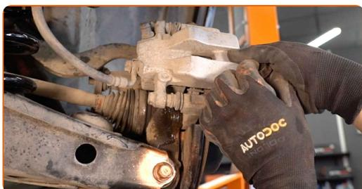
**32** Σφίξτε τη βάση της δαγκάνας των φρένων. Χρησιμοποιήστε ένα καρυδάκι #18. Χρησιμοποιήστε ένα δυναμόκλειδο. Σφίξτε τη με ροπή 88 Nm.
