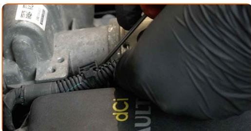
**8** Ξεβιδώστε το στοιχείο στερέωσης του καλύμματος του κινητήρα. Χρησιμοποιήστε ένα καρυδάκι #10. Χρησιμοποιήστε μια καστανία.
