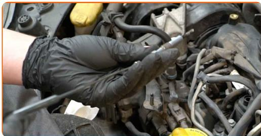
**14** Επεξεργαστείτε τους προθερμαντήρες. Χρησιμοποιήστε το γράσο μπεκ ψεκασμού & προθερμαντήρα.
