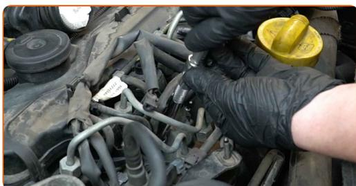
**16** Σφίξτε τους προθερμαντήρες. Χρησιμοποιήστε ένα καρυδάκι για μπουζόκλειδο #10. Χρησιμοποιήστε ένα δυναμόκλειδο. Σφίξτε τη με ροπή 15 Nm.
