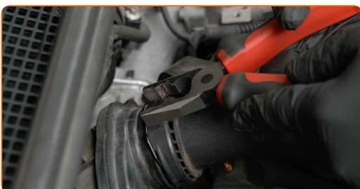
**5** Αφαιρέστε τη σωλήνα της εισαγωγής αέρα.
