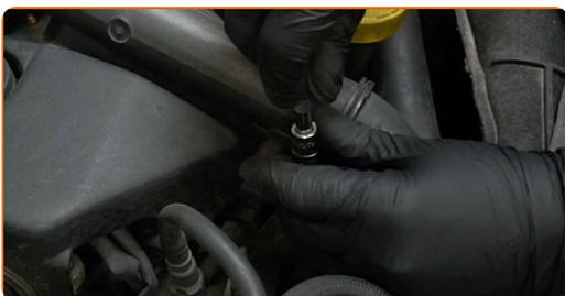
4 Βγάλτε το κολάρο του σωλήνα της εισαγωγής αέρα. Χρησιμοποιήστε μια πένσα γενικής χρήσης. Χρησιμοποιήστε ένα λοστό.
