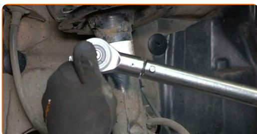
**13** Σφίξτε το στοιχείο στερέωσης που συνδέει το μπαράκι της αντιστρεπτικής στην αντιστρεπτική δοκό. Χρησιμοποιήστε ένα καρυδάκι #17. Χρησιμοποιήστε ένα δυναμόκλειδο. Σφίξτε τη με ροπή 44 Nm.
