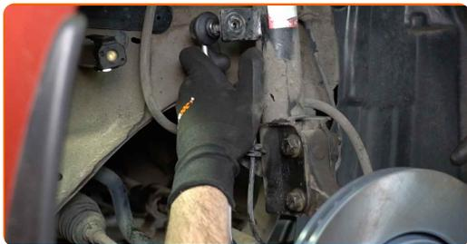
**12** Σφίξτε το στοιχείο στερέωσης που συνδέει το μπαράκι της αντιστρεπτικής στο γόνατο του αμορτισέρ. Χρησιμοποιήστε ένα καρυδάκι #17. Χρησιμοποιήστε ένα δυναμόκλειδο. Σφίξτε τη με ροπή 44 Nm.
