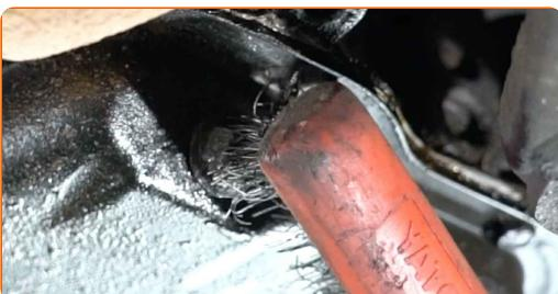
**8** Ξεβιδώστε την τάπα αποστράγγισης. Χρησιμοποιήστε ένα καρυδάκι #14. Χρησιμοποιήστε μια καστάνια.
