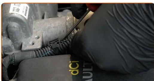
**8** Ξεβιδώστε το στοιχείο στερέωσης του καλύμματος του κινητήρα. Χρησιμοποιήστε ένα καρυδάκι #10. Χρησιμοποιήστε μια κασάνια.
