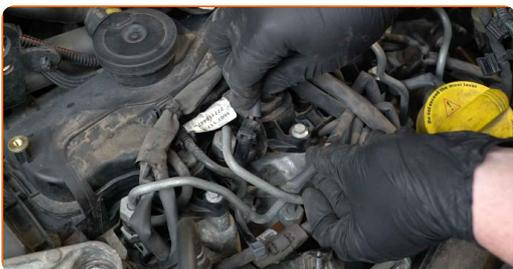
**12** Ξεβιδώστε τους προθερμαντήρες. Χρησιμοποιήστε ένα καρυδάκι για μπουζόκλειδο #10. Χρησιμοποιήστε μια κασάνια.
