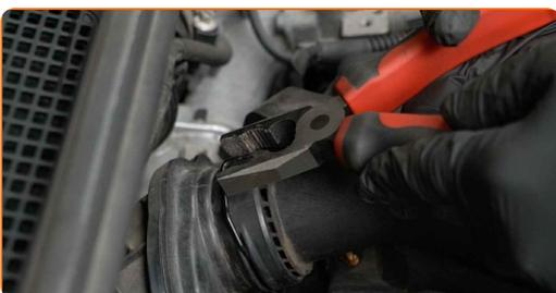
**5** Αφαιρέστε τη σωλήνα της εισαγωγής αέρα.
