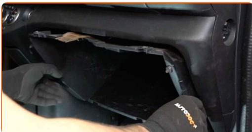
10 Βιδώστε τις βίδες στερέωσης του ντουλαπιού συνοδηγού. Χρησιμοποιήστε ένα σταυροκατσάβιδο.
