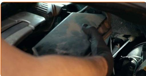
17 Τοποθετήστε τον σωλήνα εισαγωγής αέρα και ασφαλίστε τον.
