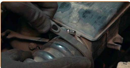
5 Βγάλτε το περίβλημα του αγωγού της εισαγωγής αέρα από το περίβλημα του φίλτρου αέρα.
