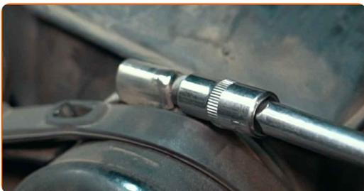
**4** Βγάλτε το κολάρου του αεραγωγού. Αφαιρέστε τον σωλήνα εισαγωγής αέρα.
