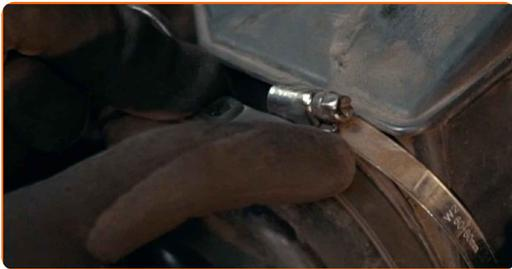
19 Βιδώστε το σφιγκτήρα στερέωσης που συνδέει την εισαγωγή αέρα στο περίβλημα του φίλτρου αέρα. Χρησιμοποιήστε ένα καρυδάκι #7. Χρησιμοποιήστε μια μανέλα κολαούζου.
