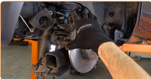
**27** Σφίξτε τη βάση της δαγκάνας των φρένων. Χρησιμοποιήστε ένα καρυδάκι #E16. Χρησιμοποιήστε ένα δυναμόκλειδο. Σφίξτε τη με ροπή 105 Nm.
