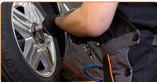
**35** Χαμηλώστε το αυτοκίνητο και χρησιμοποιήστε σταυρό, προκειμένου να σφίξετε τα μπουλόνια των τροχών. Χρησιμοποιήστε ένα δυναμόκλειδο. Σφίξτε τη με ροπή 110 Nm.
