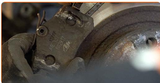
**13** Καθαρίστε τα στοιχεία στερέωσης της βάσης της δαγκάνας των φρένων. Χρησιμοποιήστε μια συρματόβουρτσα. Χρησιμοποιήστε σπρέι WD-40.
