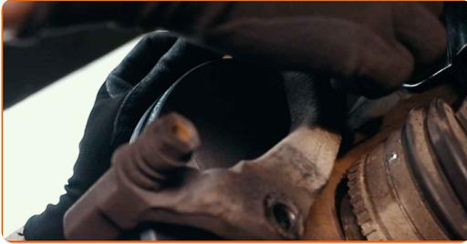
23 Σφίξτε τη βάση της δαγκάνας των φρένων. Χρησιμοποιήστε ένα καρυδάκι #18. Χρησιμοποιήστε ένα δυναμόκλειδο. Σφίξτε τη με ροπή 100 Nm.
