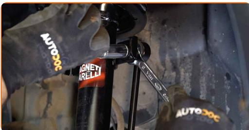
**12** Σφίξτε το στοιχείο στερέωσης που συνδέει το μπαράκι της αντιστρεπτικής στην αντιστρεπτική δοκό. Χρησιμοποιήστε ένα καρυδάκι #14. Χρησιμοποιήστε ένα γερμανοπολύγωνο #15. Χρησιμοποιήστε ένα δυναμόκλειδο. Σφίξτε τη με ροπή 44 Nm.
