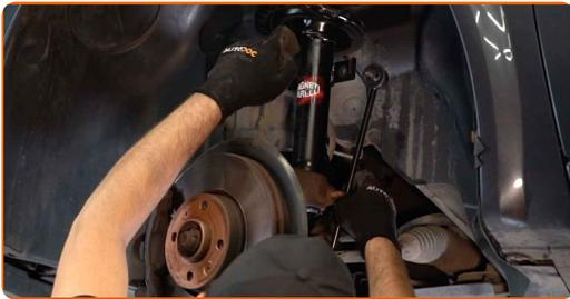
**11** Σφίξτε το στοιχείο στερέωσης που συνδέει το μπαράκι της αντιστρεπτικής στο γόνατο του αμορτισέρ. Χρησιμοποιήστε ένα καρυδάκι #14. Χρησιμοποιήστε ένα γερμανοπολύγωνο #15. Χρησιμοποιήστε ένα δυναμόκλειδο. Σφίξτε τη με ροπή 44 Nm.
