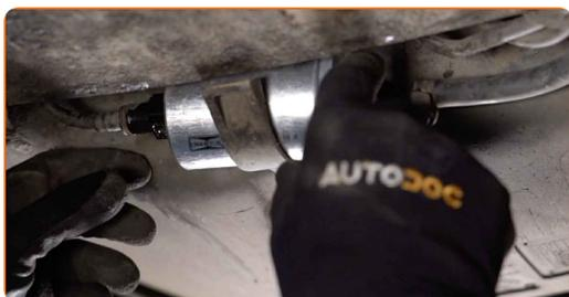
**11** Σφίξτε τα στοιχεία στερέωσης του φίλτρου καυσίμου. Χρησιμοποιήστε ένα σταυροκατσάβιδο.
