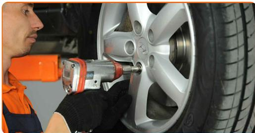
**19** Χαμηλώστε το αυτοκίνητο και χρησιμοποιήστε σταυρό, προκειμένου να σφίξετε τα μπουλόνια των τροχών. Χρησιμοποιήστε κρουστικό καρυδάκι για μπουλονόκλειδο No #21. Χρησιμοποιήστε ένα δυναμόκλειδο. Σφίξτε τη με ροπή 108 Nm.
