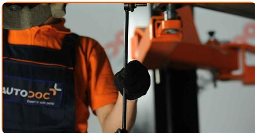
**12** Σφίξτε το στοιχείο στερέωσης που συνδέει το μπαράκι της αντιστρεπτικής στην αντιστρεπτική δοκό. Χρησιμοποιήστε ένα γερμανοπολύγωνο #17. Χρησιμοποιήστε ένα καρυδάκι #17. Χρησιμοποιήστε ένα δυναμόκλειδο. Σφίξτε τη με ροπή 65 Nm.
