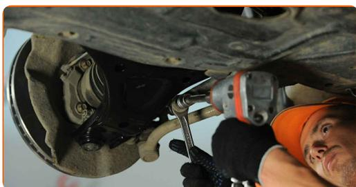
**13** Σφίξτε το στοιχείο στερέωσης που συνδέει το μπαράκι της αντιστρεπτικής στο γόνατο του αμορτισέρ. Χρησιμοποιήστε ένα γερμανοπολύγωνο #17. Χρησιμοποιήστε ένα καρυδάκι #17. Χρησιμοποιήστε ένα δυναμόκλειδο. Σφίξτε τη με ροπή 65 Nm.
