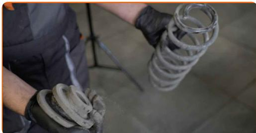
**16** Καθαρίστε τις βάσεις τοποθέτησης του σπειροειδούς ελατηρίου. Χρησιμοποιήστε μια συρματόβουρτσα. Χρησιμοποιήστε σπρέι WD-40.
