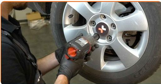
**36** Χαμηλώστε το αυτοκίνητο και χρησιμοποιήστε σταυρό, προκειμένου να σφίξετε τα μπουλόνια των τροχών. Χρησιμοποιήστε κρουστικό καρυδάκι για μπουλονόκλειδο No #17. Χρησιμοποιήστε ένα δυναμόκλειδο. Σφίξτε τη με ροπή 120 Nm.
