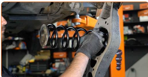
**19** Καθαρίστε τις βάσεις τοποθέτησης και το σπείρωμα του ψαλιδιού της ανάρτησης. Χρησιμοποιήστε μια συρματόβουρτσα. Χρησιμοποιήστε σπρέι WD-40.
