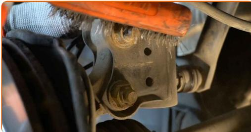
**9** Ξεβιδώστε το κάτω στοιχείο στερέωσης που συνδέει το γόνατο του αμορτισέρ με το μουαγιέ. Χρησιμοποιήστε ένα γερμανοπολύγωνο #18. Χρησιμοποιήστε ένα καρυδάκι #18. Χρησιμοποιήστε μια καστάνια.
