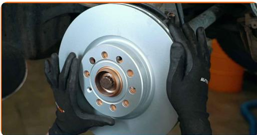
**24** Σφίξτε τις βίδες του δίσκου των φρένων. Χρησιμοποιήστε ένα Τορξ T30. Χρησιμοποιήστε ένα δυναμόκλειδο. Σφίξτε τη με ροπή 4 Nm.
