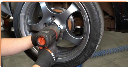
29 Χαμηλώστε το αυτοκίνητο και χρησιμοποιήστε σταυρό, προκειμένου να σφίξετε τα μπουλόνια των τροχών. Χρησιμοποιήστε κρουστικό καρυδάκι για μπουλονόκλειδο Νο #17. Χρησιμοποιήστε ένα δυναμόκλειδο. Σφίξτε τη με ροπή 110 Nm.
