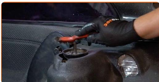
3 Χαλαρώστε το επάνω στοιχείο στερέωσης της βάσης του γονάτου του αμορτισέρ. Χρησιμοποιήστε ένα γερμανοπολύγωνο #17. Χρησιμοποιήστε ένα καρυδάκι αμορτισέρ DDN<sup>®</sup>6. Χρησιμοποιήστε μια κασάνια.
