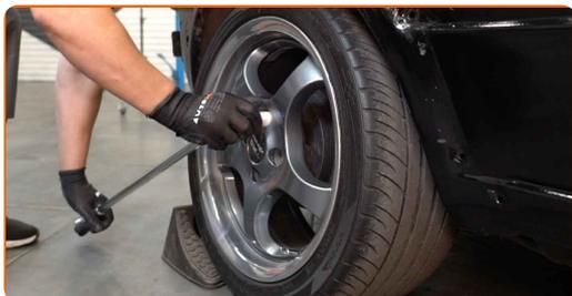
**6** Σηκώστε το πίσω μέρος του αυτοκινήτου και στερεώστε το σε στηρίγματα.
