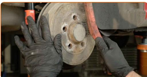
**7** Ξεβιδώστε τα στοιχεία σύσφιξης του ταμπούρου των φρένων. Χρησιμοποιήστε ένα Τορξ T30. Χρησιμοποιήστε μια καστίνα.
