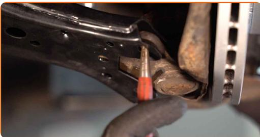
**23** Σφίξτε τα στοιχεία στερέωσης του μπαλακιού του ακρόμπαρου. Χρησιμοποιήστε ένα καρυδάκι #13. Χρησιμοποιήστε ένα δυναμόκλειδο. Σφίξτε τη με ροπή 20 Nm.+90°
