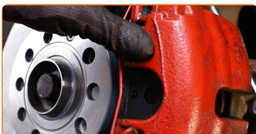
**25** Καθαρίστε το σημείο τοποθέτησης της ζάντας του τροχού. Χρησιμοποιήστε μια συρματόβουρτσα.
