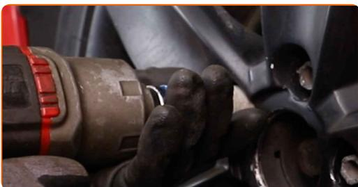
30 Χαμηλώστε το αυτοκίνητο και χρησιμοποιήστε σταυρό, προκειμένου να σφίξετε τα μπουλόνια των τροχών. Χρησιμοποιήστε κρουστικό καρυδάκι για μπουλονόκλειδο Νο #17. Χρησιμοποιήστε ένα δυναμόκλειδο. Σφίξτε τη με ροπή 120 Nm.
