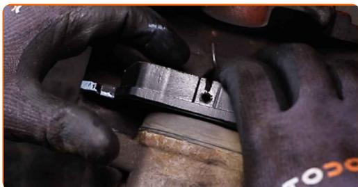
**21** Τοποθετήστε τη δαγκάνα του φρένου και σφίξτε τη. Χρησιμοποιήστε ένα Άλεν No.H7. Χρησιμοποιήστε μια κασάνια.
