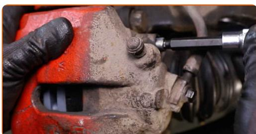
**22** Σφίξτε τα στοιχεία στερέωσης της δαγκάνας του φρένου. Χρησιμοποιήστε ένα Άλεν No.H7. Χρησιμοποιήστε ένα δυναμόκλειδο. Σφίξτε τη με ροπή 30 Nm.
