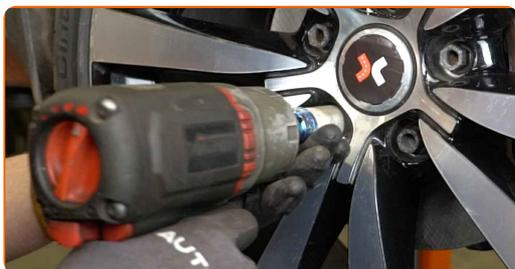
**41** Χαμηλώστε το αυτοκίνητο και χρησιμοποιήστε σταυρό, προκειμένου να σφίξετε τα μπουλόνια των τροχών. Χρησιμοποιήστε κρουστικό καρυδάκι για μπουλονόκλειδο Νο #17. Χρησιμοποιήστε ένα δυναμόκλειδο. Σφίξτε τη με ροπή 120 Nm.
