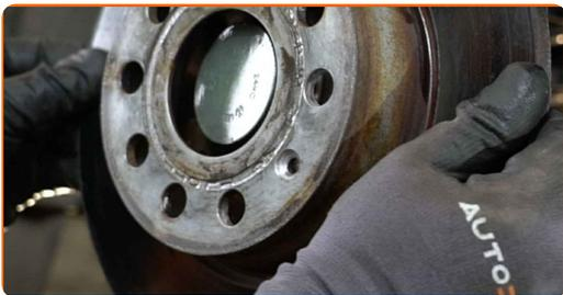
**21** Καθαρίστε την πλήμνη. Χρησιμοποιήστε μια συρματόβουρτσα. Χρησιμοποιήστε ένα σπρέι καθαρισμού γενικής χρήσης.
