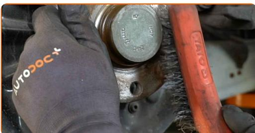
**22** Καθαρίστε το σημείο επαφής. Χρησιμοποιήστε κεραμικό γράσο.
