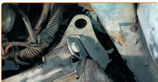
**70** Βιδώστε τα στοιχεία στερέωσης που συνδέουν τη βάση του κιβωτίου ταχυτήτων στο κιβώτιο ταχυτήτων. Χρησιμοποιήστε ένα γερμανοπολύγωνο #16.
