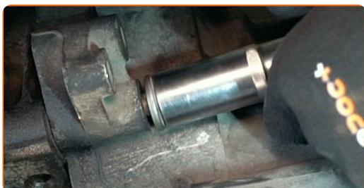
**68** Σφίξτε τα στοιχεία στερέωσης που συνδέουν το κιβώτιο ταχυτήτων στο μπλοκ κινητήρα. Χρησιμοποιήστε ένα καρυδάκι #18. Χρησιμοποιήστε ένα δυναμόκλειδο. Σφίξτε τη με ροπή 64 Nm.
