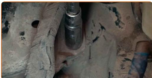
**75** Σφίξτε τα στοιχεία στερέωσης που συνδέουν τη βάση του κιβωτίου ταχυτήτων στο κιβώτιο ταχυτήτων. Χρησιμοποιήστε ένα καρυδάκι #18. Χρησιμοποιήστε ένα δυναμόκλειδο. Σφίξτε τη με ροπή 69 Nm.
