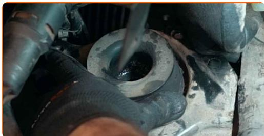
**73** Βιδώστε τα στοιχεία στερέωσης που συνδέουν τη βάση του κιβωτίου ταχυτήτων στο αμάξωμα. Χρησιμοποιήστε ένα καρυδάκι #18. Χρησιμοποιήστε μια κασάνια.
