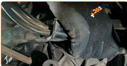
**14** Ξεβιδώστε τα στοιχεία στερέωσης της μίζας του κινητήρα. Χρησιμοποιήστε ένα καρυδάκι #13. Χρησιμοποιήστε μια καστάνια.
