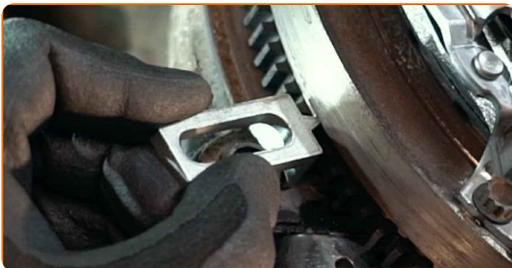
**60** Σφίξτε τα στοιχεία στερέωσης της πλάκας πίεσης. Χρησιμοποιήστε ένα πολύσφηνο καρυδάκι (12 δοντιών) No.9. Χρησιμοποιήστε ένα δυναμόκλειδο. Σφίξτε τη με ροπή 27 Nm.
