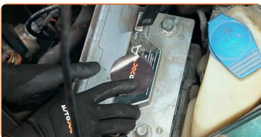
**118** Βιδώστε τα στοιχεία στερέωσης της μπαταρίας. Χρησιμοποιήστε ένα καρυδάκι #13. Χρησιμοποιήστε μια κασάνια.
