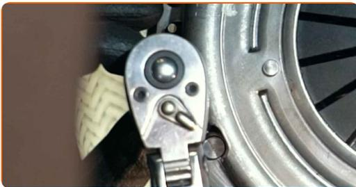
**59** Εγκαταστήστε το εργαλείο ασφάλισης του βολάν του κινητήρα. Χρησιμοποιήστε ένα σετ εργαλείων συμπλέκτη.
