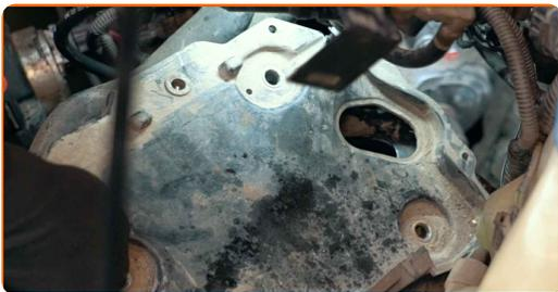
**116** Βιδώστε τα στοιχεία στερέωσης του δίσκου μπαταρίας. Χρησιμοποιήστε ένα καρυδάκι #10. Χρησιμοποιήστε μια κασάνια.
