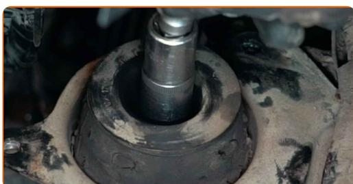
**74** Σφίξτε τα στοιχεία στερέωσης που συνδέουν τη βάση του κιβωτίου ταχυτήτων στο αμάξωμα. Χρησιμοποιήστε ένα καρυδάκι #13. Χρησιμοποιήστε ένα δυναμόκλειδο. Σφίξτε τη με ροπή 38 Nm.
