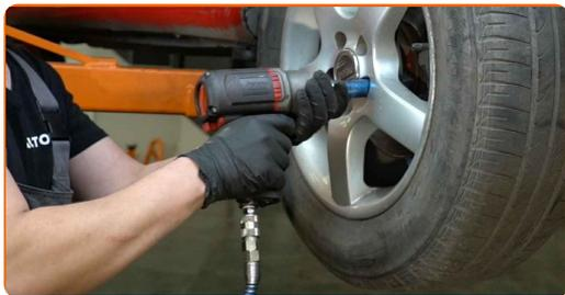
**28** Χαμηλώστε το αυτοκίνητο και χρησιμοποιήστε σταυρό, προκειμένου να σφίξετε τα μπουλόνια των τροχών. Χρησιμοποιήστε κρουστικό καρυδάκι για μπουλονόκλειδο No #17. Χρησιμοποιήστε ένα δυναμόκλειδο. Σφίξτε τη με ροπή 120 Nm.
